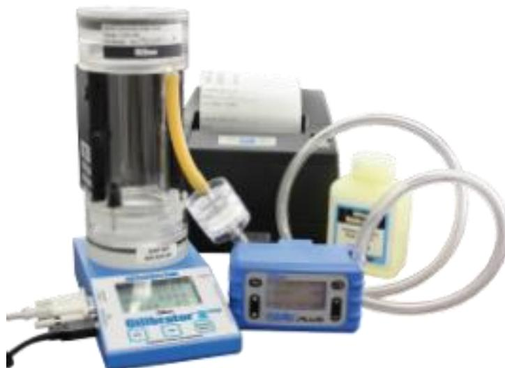
*Gilibrator 2<sup>USB</sup> exibido, calibrando a amostragem de ar da Bomba GilAir Plus, com kit de impressora opcional e solução de bolha de sabão*
